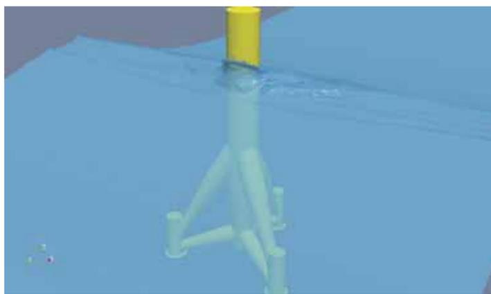
Die 3D-Modellierung zeigt die Strömung im Nahfeld einer Tripod-Gründung für eine Offshore-Windenergieanlage. Grafik: Prof. Dr.-Ing. Jann Strybny
