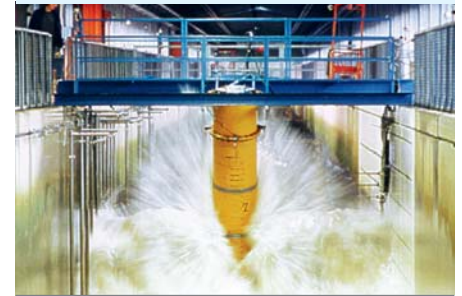
Die Welle bricht an einem Pfahl. Nur durch großmaßstäbliche Modellversuche lassen sich die Kräfte durch brechende Wellen exakt bestimmen und Bauwerke entsprechend bemessen.
