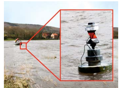
Das neue, kostengünstige Messsystem bestimmt hochpräzise die Fließgeschwindigkeit der Weser.
