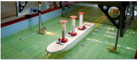
Modellversuche zu Flettner-Rotoren: Von Wind angeströmte rotierende Zylinder auf Schiffen lassen erhebliche Energieeinsparungen erwarten.
