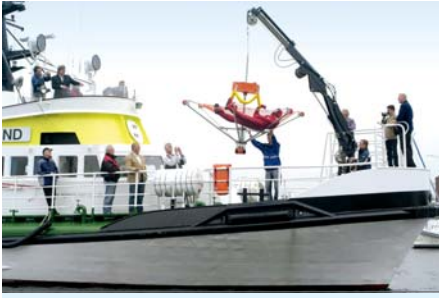
Das Rettungsgerät Rescue Star A/VE ist schnell einsatzbereit und kann in Seenot geratene Personen besonders schonend und sicher wieder an Bord heben.
